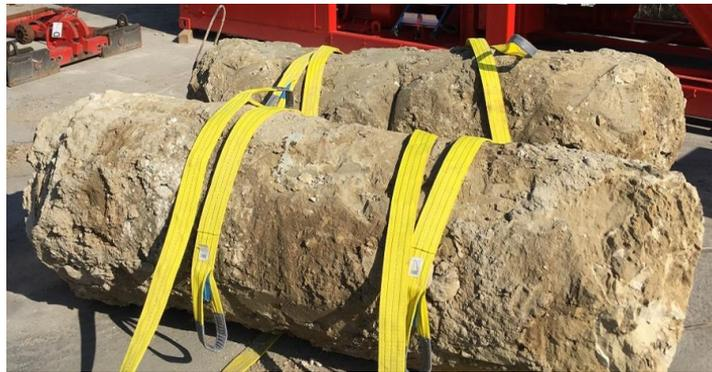
Figure 1. Colonnes de Soil Mixing excavées après 21 jours
