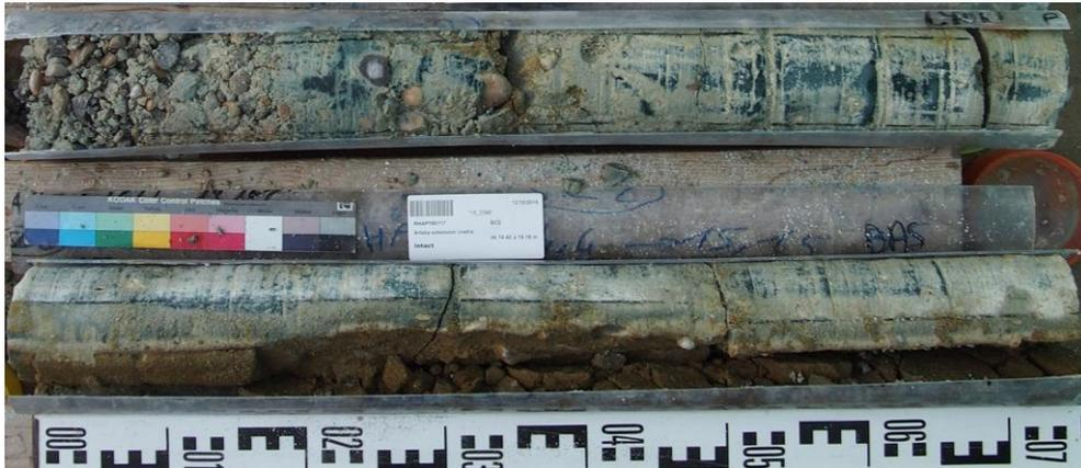
Figure 4. Photographie de prélèvement sous gaine (13,65 m à 15,15 m).
