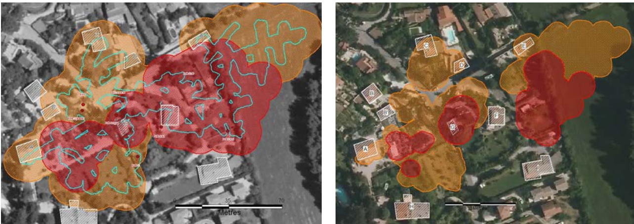
Figure 2. Mine des Camoins – Comparaison des zones d'aléa effondrement localisé en 2011 (à gauche) et 2019 (à droite) – rouge : niveau fort / orange : niveau moyen
