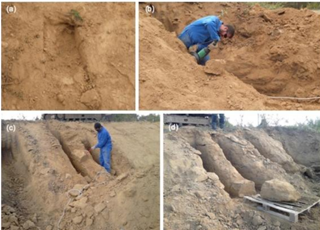
Figure 5. Tentative de récupération d'échantillon intact (a) à la tronçonneuse, (b) à la disqueuse, (c) à partir de deux tranchées de 30 cm de large espacées de 50 cm, (d) au perforateur perpendiculairement à la pente du talus.
