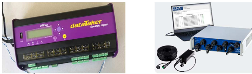
Figure 4. À gauche, la centrale Datataker et à droite, la centrale optique
