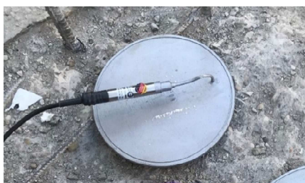
Figure 3. Capteur de pression totale installé sur une tête de pieu
