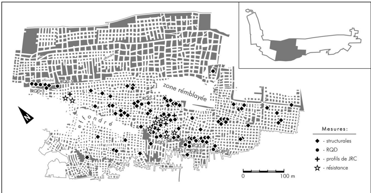
Figure 3. Plan de la carrière de la Malogne (source : SPW) avec localisation des levés structuraux, des mesures de RQD, des profils de JRC et de résistance.
