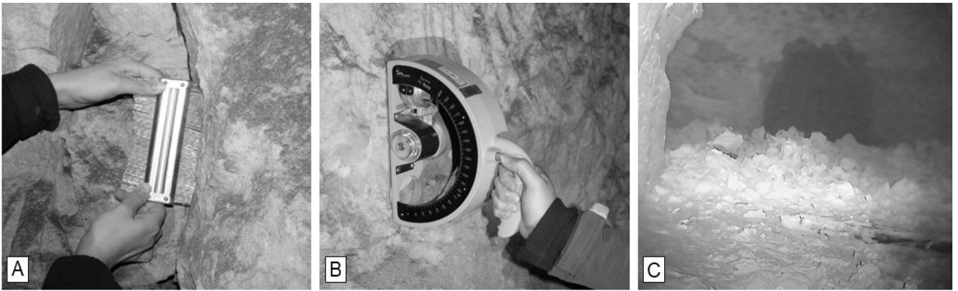
Figure 5. Mesures in situ (A) de la rugosité des joints (JRC) ; (B) de la résistance de la roche avec le marteau de Schmidt type PT et exemple (C) de blocs détachés dans la zone ennoyée.
