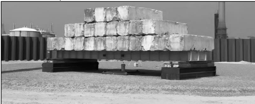
Figure 9. Essai de chargement système Kentledge
