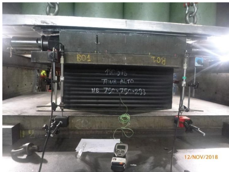
Figure 7. Photo de l'appui C en cours d'essai de compression
