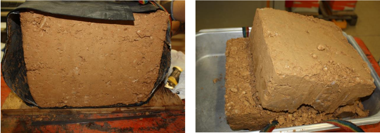
Figure 1. Vues de l'éprouvette traitée avant essai (à gauche) et après cisaillement (à droite).
