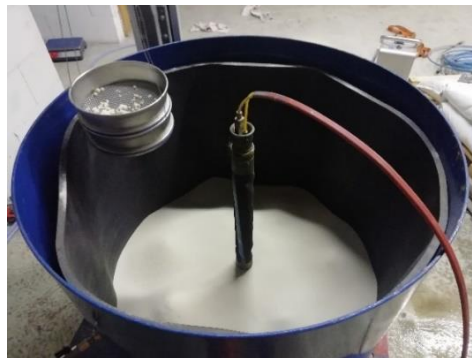
Figure 3. Sonde fixée dans le centre de la chambre et sable déposé par pluviation autour d'elle.
